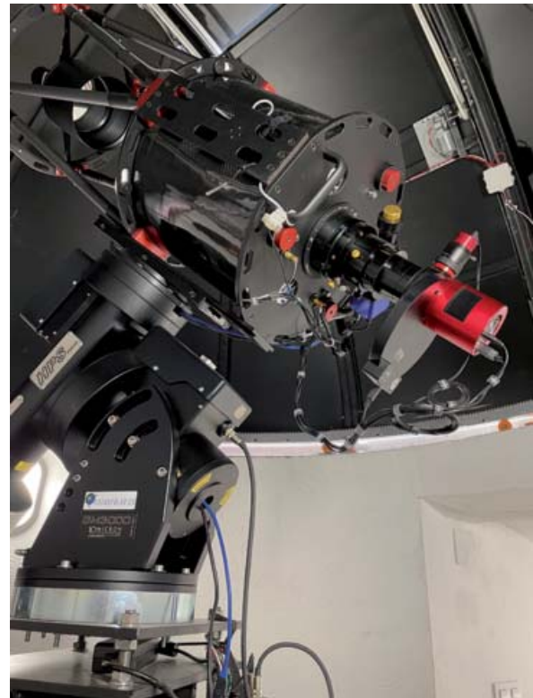
Detalle del tren óptico con la cámara CCD.
